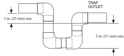
Fig. 11 - Condensate Trap
