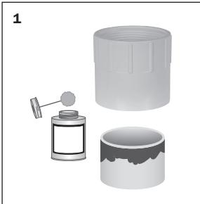
Pegue el adaptador al tubo usando un cemento a solvente apropiado.
