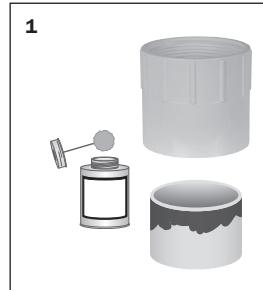
Coller l'adaptateur au tuyau à l'aide d'une colle à solvant appropriée.
