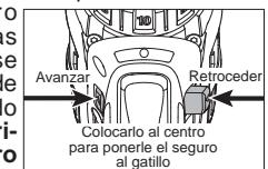
Para **avanzar** (el giro es en el sentido de las manecillas del reloj), se presiona el interruptor de control colocado al lado derecho del taladro. **Verificar la dirección del giro antes de usarlo.**
