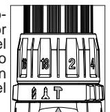
**NOTA:** El número seleccionado en el collarín de par de apriete no tiene efecto en el funcionamiento del taladro en el modo de taladrado. **NOTA:** Cuando se usen brocas de carburo, no use agua para asentar el polvo. No intente taladrar varillas de refuerzo de acero. Esto dañará las brocas de carburo.
