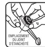
Si vous remplacez le joint d'étanchéité : utilisez seulement un joint d'étanchéité Fluidmaster 242 authentique.
