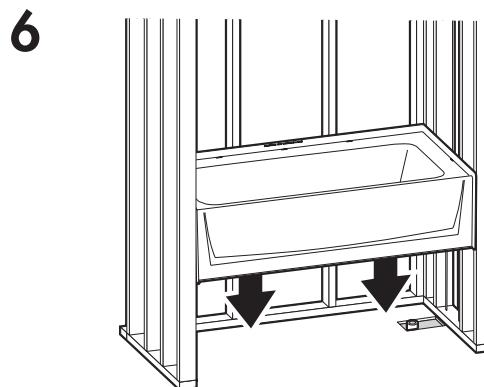
Coloque la base en la cavidad del armazón de montaje.
