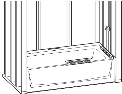
Tassez vers le bas jusqu'à ce que l'unité soit de niveau. Assurez-vous que la baignoire est à niveau sur la longueur et la largeur en utilisant un niveau de 915 mm (3 pi), en utilisant des cales ou en étalant le matériau de fondation. La baignoire doit être à niveau.
