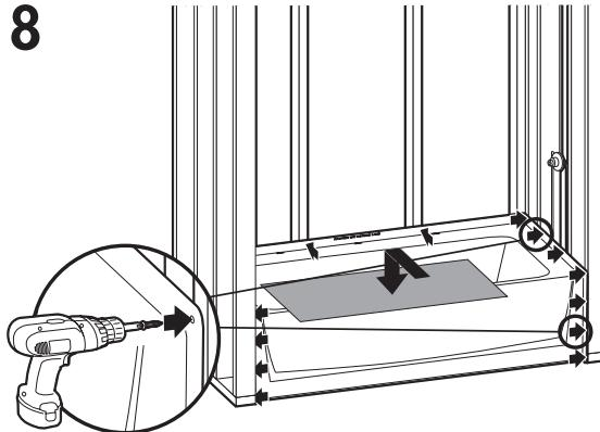
Prépercez les brides horizontales le long de la partie supérieure de la base et fixez-les dans chaque montant correspondant. Prépercez les deux brides (verticales) latérales et fixez-les aux montants latéraux en les espacant de 200 mm (8 po). Recouvrez de carton pour protéger la finition.
