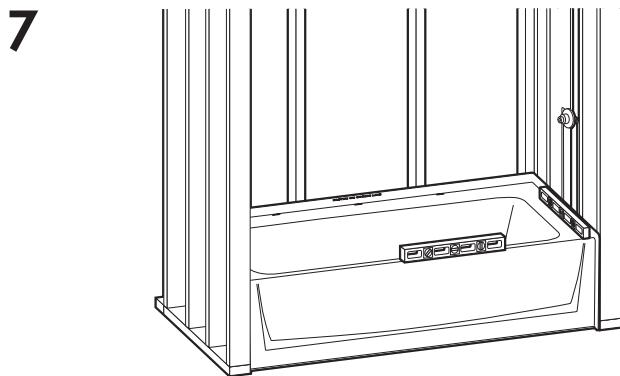
Nivele bien dando unos ligeros golpes. Para nivelar la unidad, use un nivel de 3 pies (915 mm) a lo largo y a lo ancho de la unidad y acuña o presione para aplanar los materiales de relleno y cimentación según lo necesite. La unidad debe quedar nivelada.
