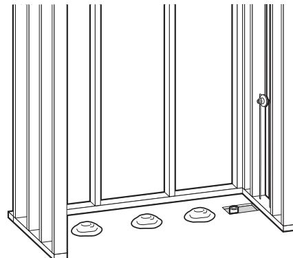
Installez l'assemblage de drainage conformément aux directives du fabricant. Si nécessaire, appliquez des matériaux de fondation. Les éléments suivants s'appliquent lors de l'utilisation de matériau de fondation : Mélangez le matériau de fondation. Placez trois ou quatre monticules de plâtre sur le sous-plancher autour, mais en évitant l'orifice de vidange. Les monticules doivent être assez élevés pour que le plâtre se déplace et s'étale lorsque l'unité est mise en place.
