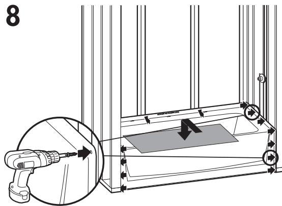
Perfore previamente los rebordes horizontales en la parte superior de la sección de la base y clave o atornille a todos los montantes correspondientes. Perfore previamente los dos rebordes laterales (verticales) y clave o atornille a los montantes laterales de 8" (200 mm) en el centro. Coloque un cartón para proteger el acabado.
