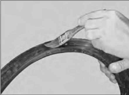
**4b. LUBRICATE FLANGE GASKET:**
