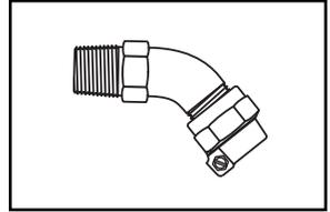
MALE IRON PIPE THREAD BY PACK JOINT FOR COPPER OR PLASTIC TUBING (CTS)
