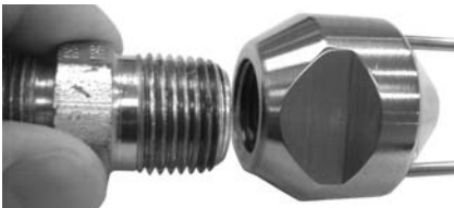
Figure 4 – Montage de l'adaptateur sur le cône
