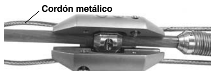
Figura 6 – Colocación del bulbo de la varilla de empuje dentro del casquillo
