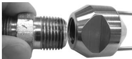
Figura 4 – Instalación del adaptador en el cono
