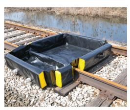
Este cojín de contenimiento ligero es diseñado para proveer una berma temporal alrededor las válvulas debajo del vagón cisterna durante la operación carga/descarge. Pesyo solamente 80 libras, solamente requiere dos operadores.
