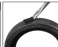
**5. FOR REASSEMBLY OF STYLE 009N COUPLINGS, LUBRICATE GASKET:**
