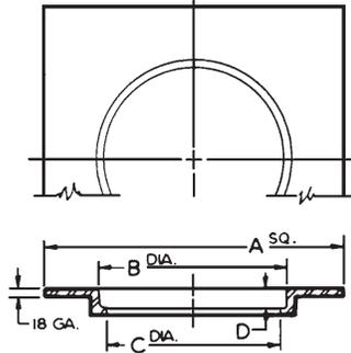
**(-CR) CLAMPING DRAIN RECEIVER**
