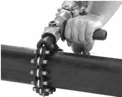
Figura 5 – Funcionamiento de la Cortadora de tubos cloacales impulsada por una herramienta de impacto
