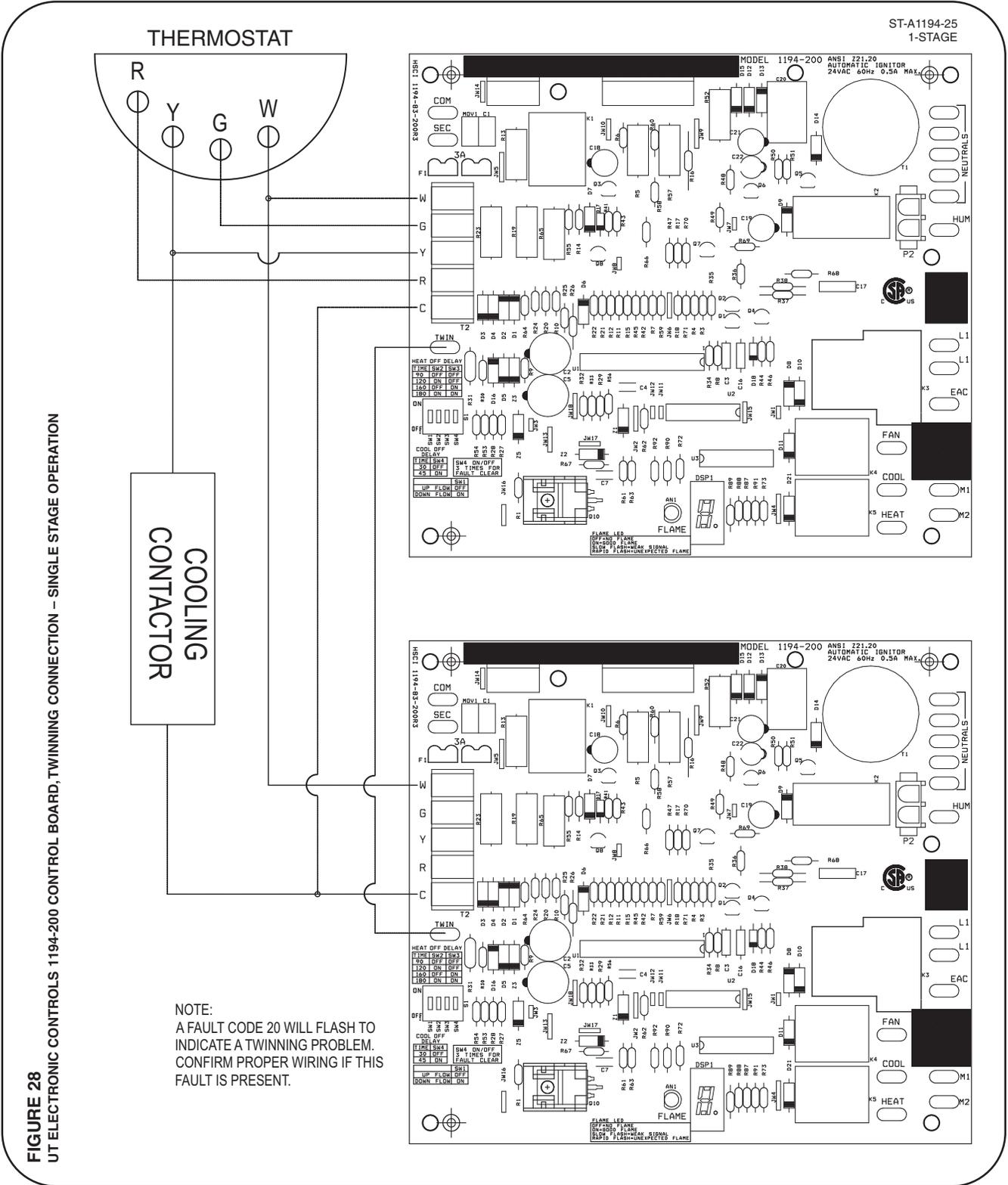
**FIGURE 28** UT ELECTRONIC CONTROLS 1194-200 CONTROL BOARD, TWINNING CONNECTION – SINGLE STAGE OPERATION
