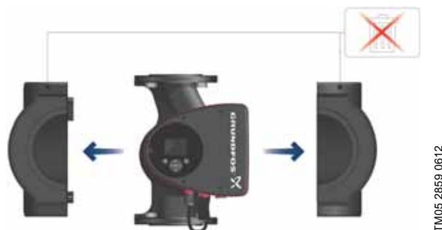
Fig. 3 Instalación de una carcasa aislante en la bomba
