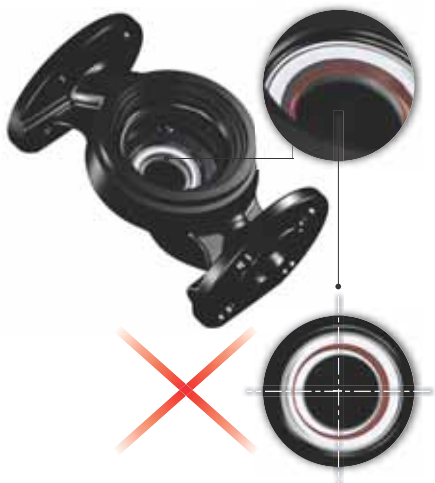
Fig. 11 Système de garniture mal centré
