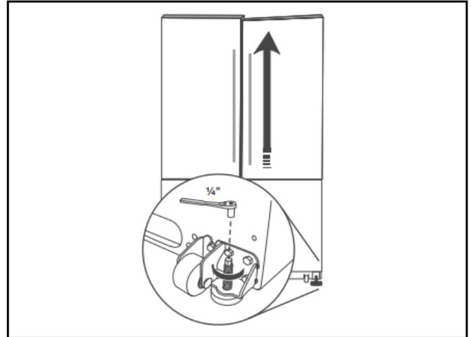
6. S'assurer que le réfrigérateur est stable. Si le réfrigérateur semble instable ou qu'il roule vers l'avant lorsqu'on ouvre la porte ou le tiroir, ajuster les vis de nivellement. À l'aide d'un tourne-écrou à tête hexagonale de 1/4 po, tourner les vis de nivellement dans le sens horaire de chaque côté jusqu'à ce que les pieds de nivellement soient en contact ferme avec le plancher.
