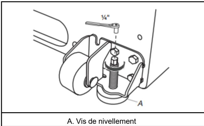
4. Ouvrir et fermer les portes pour vérifier que leur fermeture est aussi aisée que souhaité. Si ce n'est pas le cas, augmenter l'inclinaison du réfrigérateur en tournant les deux vis de nivellement dans le sens horaire. Il est possible qu'il faille appliquer plusieurs tours aux vis de nivellement pour faciliter la fermeture des portes.
