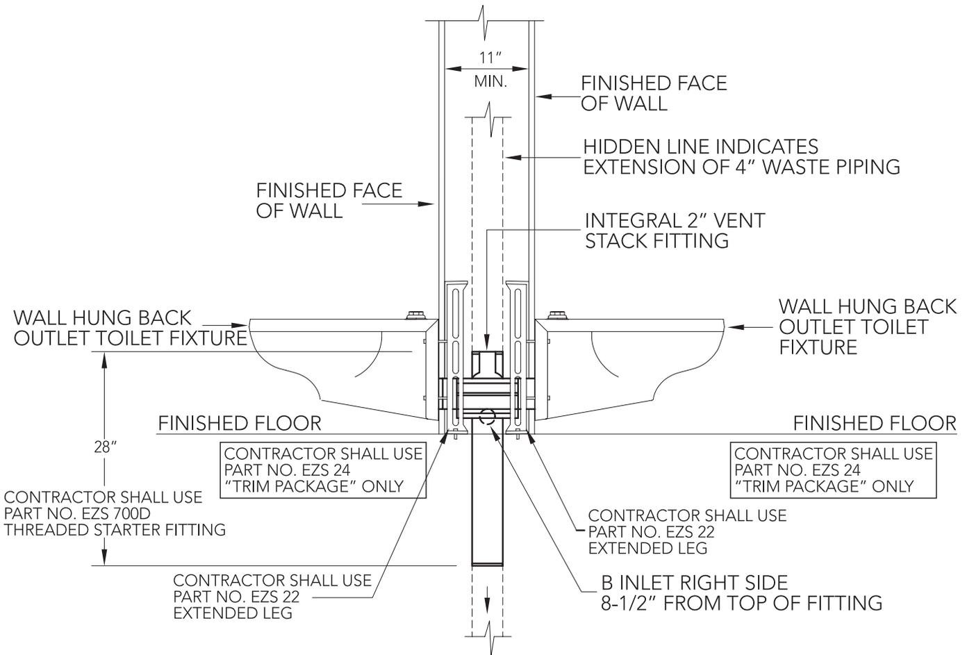
DOUBLE FITTING - LEFT SIDE ELEVATION
