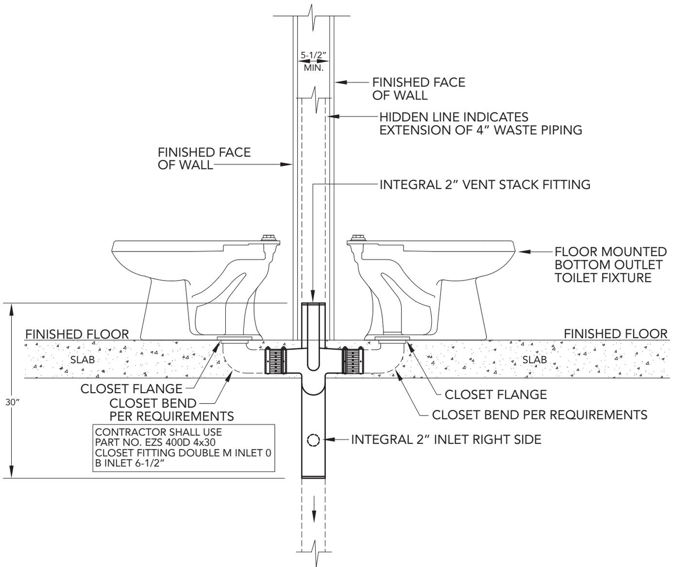
**DOUBLE FITTING IN-SLAB - LEFT SIDE ELEVATION**
