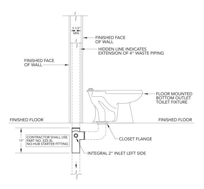
SINGLE FITTING LEFT HAND UNDER-SLAB - LEFT SIDE ELEVATION
