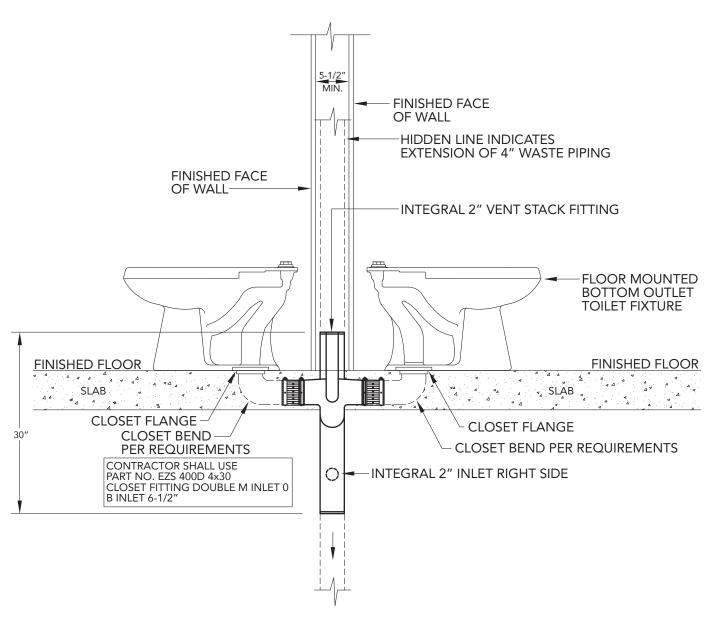
DOUBLE FITTING IN-SLAB - LEFT SIDE ELEVATION
