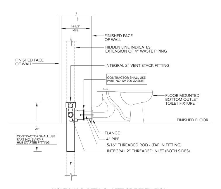
RIGHT HAND FITTING - LEFT SIDE ELEVATION
