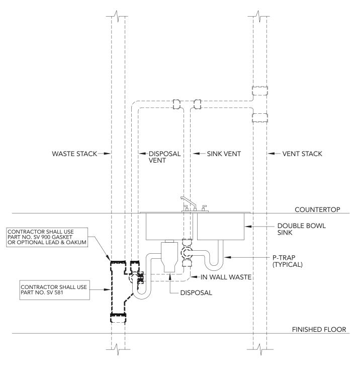
**DOUBLE SINK STACK FITTING - FRONT ELEVATION**
