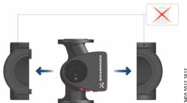
Fig. 3 Installation des coquilles d'isolation sur le circulateur
