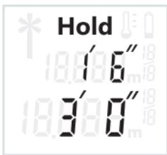
Pour interrompre une nouvelle fois le processus de mesure, actionnez à nouveau la touche « HOLD » **1**. Le faisceau laser s'éteint et l'affichage **HOLD** apparaît à l'écran. La valeur de mesure précédente s'affiche sur la ligne supérieure. La valeur de mesure actuelle s'affiche sur la ligne inférieure de l'écran mais elle n'est plus actualisée.
