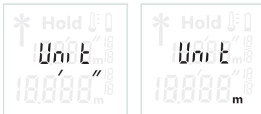
Mettez l'outil de mesure hors tension. Appuyez sur le bouton de mesure **1** et maintenez-le enfoncé. L'écran montrera alternativement les deux unités de mesure. Lorsque le réglage désiré est affiché, relâchez le bouton de mesure **1**. Le réglage est enregistré en mémoire.
