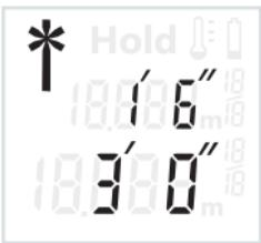
Presione de nuevo la tecla “HOLD” **1**, para conectar nuevamente el láser. La indicación **—\*** parpadea en el display. En la línea superior se indica el valor de medición precedente. En la línea inferior se indica el valor de medición actual/continuamente actualizado.
