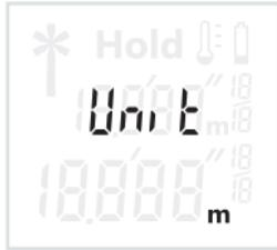
Apague la herramienta de medición. Presione el botón de medición **1** y manténgalo presionado hacia abajo. La pantalla mostrará alternadamente ambas unidades de medida. Cuando se muestre el ajuste deseado, suelte el botón de medición **1**. Se almacenará el ajuste.
