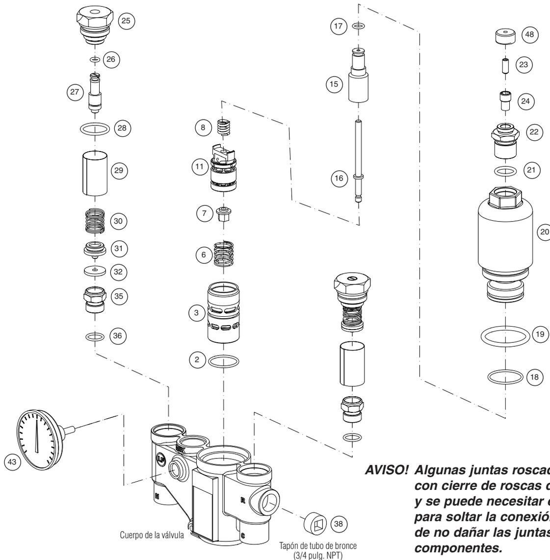
**AVISO!** Algunas juntas roscadas se montan con cierre de roscas de alta resistencia y se puede necesitar el uso de calor para soltar la conexión. Tenga cuidado de no dañar las juntas tóricas y otros componentes.
