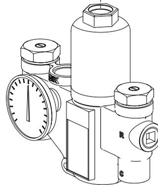
Si la tige se déplace de moins de 12,7 mm (1/2 po), le piston ne se déplace pas librement en dedans du revêtement et doit être nettoyé :
