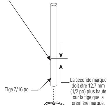
**D** Pousser le mécanisme en haut et en bas plusieurs fois pour s'assurer que le piston se déplace librement et de façon constante. Si non constant, répéter la Procédure C jusqu'à satisfaction, ou remplacer. Contacter votre représentant Bradley et lui demander un Kit de Piston/Revêtement (référence S65-489).
