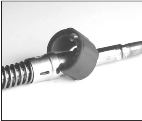
FIG. 41: REMOVE EXHAUST RING
