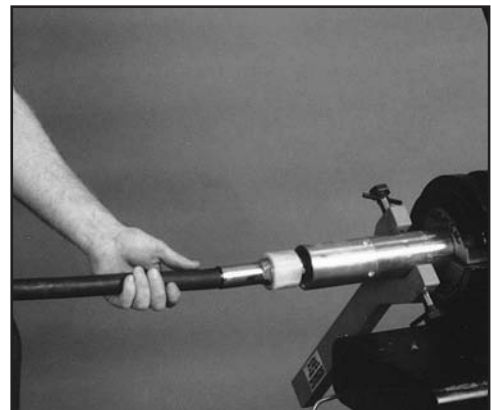
FIG. 40: REMOVE CONTROL STUD
