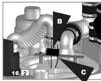
Remettre la trappe en position. Reconnecter l'évacuation. Utiliser le bouchon **F** pour obstruer la sortie des fils moteur de la trappe. Fixer avec le collier **E**.
