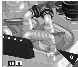
Déclipser le capot. Dévisser le collier **16** du moteur défectueux (le clapet anti-retour reste en position lors du dépannage du moteur).
