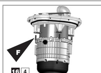
Si le moteur défectueux doit repartir chez le fabricant, vous pouvez laisser le relevé assurer un service minimum avec un seul moteur. Dévisser les vis **D** du moteur défectueux de la trappe.
