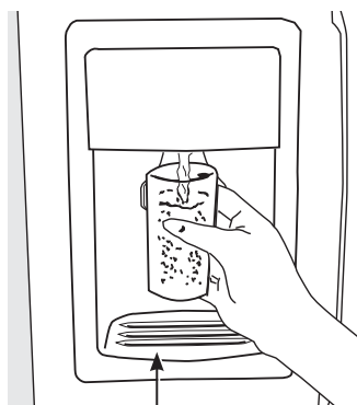
Bac de trop-plein
