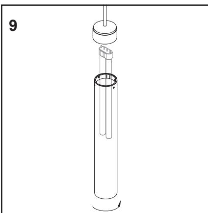
Asegure la lámpara de techo a la placa de montaje.
