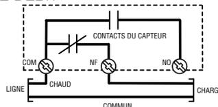
Le capteur de débit activera la charge (alarme, lumière, relais, dispositif de démarrage du moteur, etc.) en cas d'absence de débit.
