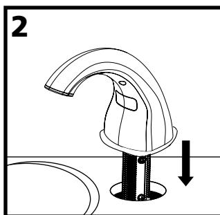
Faire glisser le câble (6) de données et la douille du distributeur (1) dans le trou du comptoir. Orienter le bec du distributeur vers l'évier et appuyer fermement sur le distributeur pour le fixer solidement au comptoir.
