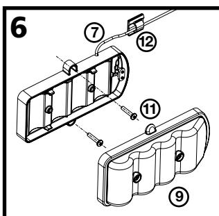
Remova a tampa da Caixa da Bateria (9) soltando os dois parafusos cativos na tampa da Caixa da Bateria. Posicione a Caixa em uma superfície conveniente (vertical ou horizontal) embaixo da bancada que vai permitir acesso para troca de bateria. Prenda a Caixa na superfície usando os dois parafusos (1) e escoras (se prender a uma superfície de reboque ou alvenaria.) Use o clipe de parede (12) para segurar o Cabo de Alimentação (7) a uma parede ou outra superfície embaixo da bancada se desejar.
