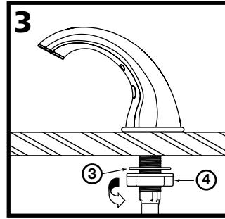
Desde debajo del mostrador, primero pase la arandela de seguridad (3) y la tuerca de montaje (4) sobre el cable de datos (6) hacia el tubo de enrosque del conjunto del dispensador (1). Asegúrese que los dientes de la arandela no toquen la parte inferior del mostrador y que la tuerca se enrosque fácilmente por el tubo. (Si la tuerca es muy difícil de enroscar manualmente, entonces está invertida). Ajuste la tuerca manualmente.
