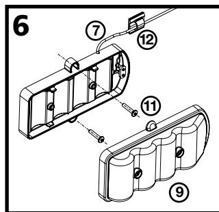
Remueva la tapa de la caja de baterías (9) soltando los tornillos. Posicione la caja en una superficie adecuada (vertical u horizontal) debajo del mostrador, la cual le permita tener acceso al momento de cambiar las baterías.
