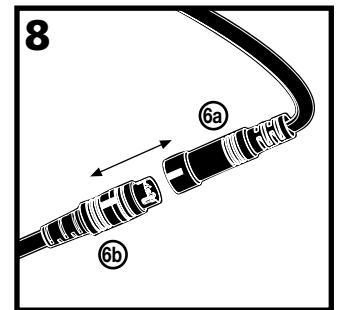
**IMPORTANTE:** Conecte los dos extremos del cable de datos (6a) y (6b), alineando visualmente las líneas blancas en cada lado y presionando suavemente los conectores de cable juntos hasta que las líneas se unan.
