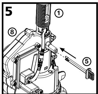
Fixe o Corpo do Motor/ Suporte do Frasco (8) à haste do Corpo do Dosador (1) empurrando o Clipe de Retenção (5) no lugar pelas ranhuras verticais, até que ele entre todo pelo Corpo de Montagem.
