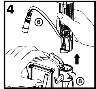
Alinhe o recorte dentro do topo da Montagem do Motor/ Suporte do Frasco (8) com o recorte na haste da Montagem do Dosador (1) e firmemente empurre a Montagem do Motor / Suporte do Frasco para cima, na haste.
