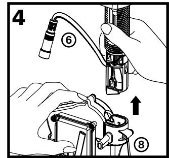
Aligner la partie dentelée à l'intérieur de la partie supérieure du moteur et du support de bouteille (8) avec la partie dentelée de la douille du distributeur (1) et pousser fermement le moteur et le support de bouteille (8) dans la douille.
