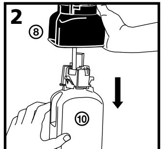
Prendre la bouteille de recharge (10) d'une main et, de l'autre main, pousser vers la droite (dans le sens contraire des aiguilles d'une montre, vue en plongée) sur le loquet de blocage vert du moteur et du support de bouteille (8).
