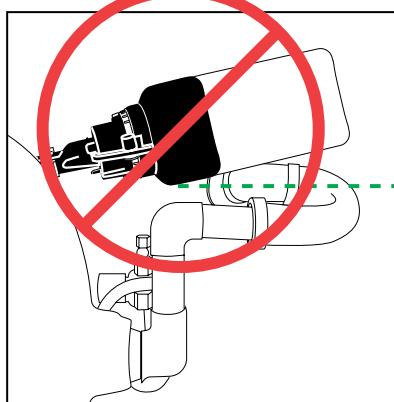
A instalação apropriada permite que o dosador esteja verticalmente suspenso embaixo da pia.
