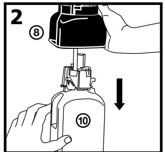
Pegue o Frasco de Refil (10) com uma mão e use a outra para empurrar a alavanca verde de soltura no Corpo do Motor / Suporte do Frasco (8) para a direita (sentido anti - horário como visto acima).
