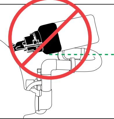
La instalación inapropiada de los sistemas para montado en mostradores puede resultar en rotura.
