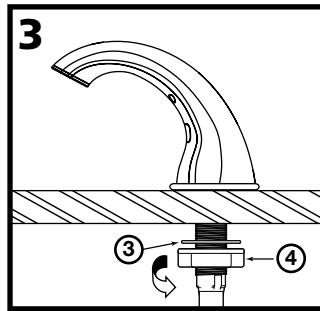
Sous le comptoir, placer la rondelle de sécurité (3) et l'écrou de fixation (4) sur le câble de données (6) et les insérer dans la douille filetée du distributeur (1). S'assurer que la « saillie » de la rondelle touche le dessous du comptoir et que l'écrou glisse facilement dans la douille. (S'il est difficile de le tourner à la main, l'écrou est à l'envers). Serrer solidement l'écrou, à la main.
