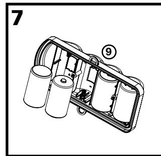
Coloque 4 baterías Alcalinas "D" (incluidas) en la tapa de la caja de baterías (9). Las baterías deben ser colocadas de acuerdo al diagrama mostrado en el interior de la tapa.
