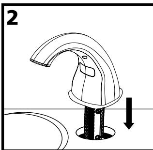
Passe o cabo de dados (6) e a haste de Montagem do Dosador (1) pelo buraco da bancada. Direcione o bico do Dosador dentro da bacia da pia e pressione firmemente sobre o Dosador, para fixá-lo seguramente na bancada.
