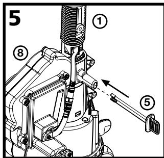
Asegure el conjunto del motor / soporte de botella (8) al conjunto del dispensador (1) presionando el clip de retención (5) en su lugar a través de las ranuras verticales, hasta que pase completamente a través del conjunto del motor.
