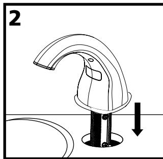
Pase el cable de datos (6) y el tubo de enrosque del conjunto del dispensador (1) a través del agujero en el mostrador. Oriente el surtidor del dispensador hacia el lavatorio y presione firmemente el dispensador para asegurarse que esté sujeto al mostrador.
