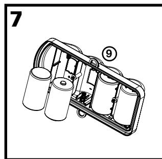
Coloque quatro baterias alcalinas "D" (incluídas) na tampa da Caixa da Bateria (9). As Baterias devem estar posicionadas de acordo com o diagrama mostrado do lado de dentro da tampa.
