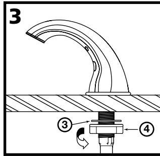
Por debaixo da bancada, primeiro passe a Ruela Travada (3) e então a porca de montagem (4) sobre o Cabo de Dados (6) e na haste rosqueada da Montagem do Dosador (1). Garanta que os "dentes" na ruela travada toquem na base da bancada e que a porca deslize facilmente rosqueando-se na haste. (Se a porca for difícil de rosquear com a mão, é porque ela está de cabeça para baixo.) Aperte a porca com a mão seguramente.
