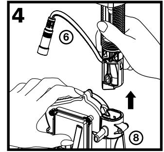
Alinee la muesca interior de la parte superior del conjunto del motor / soporte de botella (8) con la muesca en el tubo de enrosque del conjunto del dispensador (1) y presione firmemente el conjunto del motor / soporte de botella, hacia el tubo de enrosque.
