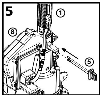
Pour fixer le moteur et le support de bouteille (8) dans la douille du distributeur (1), pousser la clé de serrage (5) dans les fentes verticales à travers l'unité de moteur.
