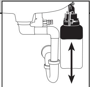
Correctement installé, le dispositif pend à la verticale sous l'évier.
