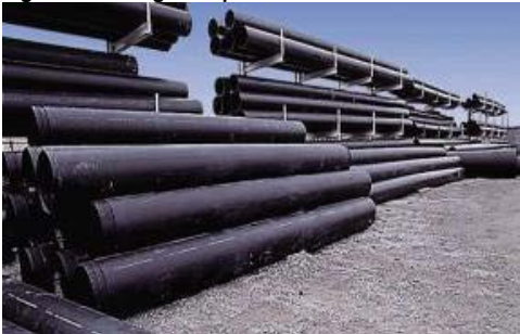
Figure 6: Storing PE Pipe
