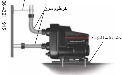
شكل 4 كيفية خفض الضوضاء في التركيب
