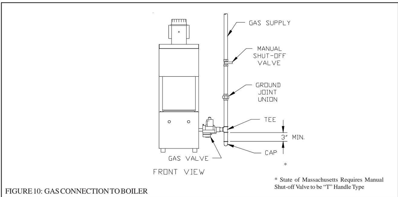
FIGURE 10: GAS CONNECTION TO BOILER
