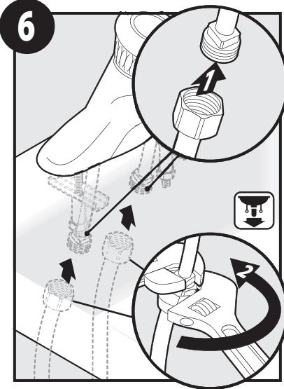
1. Conecte un extremo de cada línea de suministro flexible (no incluida) a las patas del cuerpo de la mezcladora.
