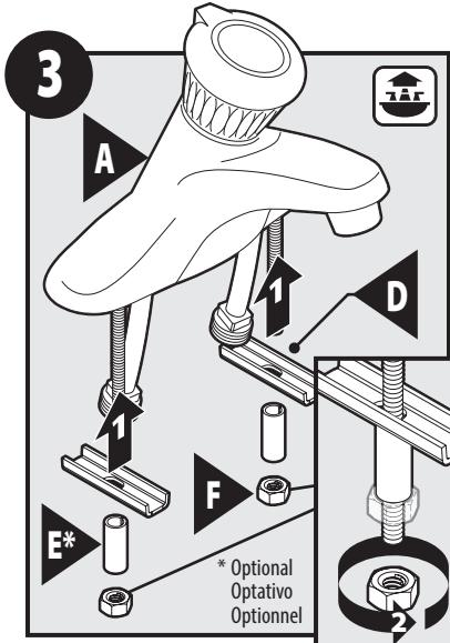
1. Instale las ménsulas de montaje (D), el manguito espaciador (E)\* (si es necesario) y las tuercas de montaje (F) en los tubos rosca-dos del cuerpo de la mezcladora (A) en este orden.
