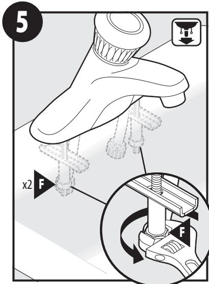
Con una llave ajustable, termine de apretar las tuercas de montaje (F) hasta que la mezcladora quede firme en el fregadero.
