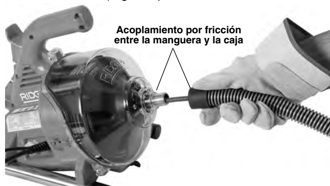
Figura 4 – Alimentación del cable dentro de la manguera-guía
