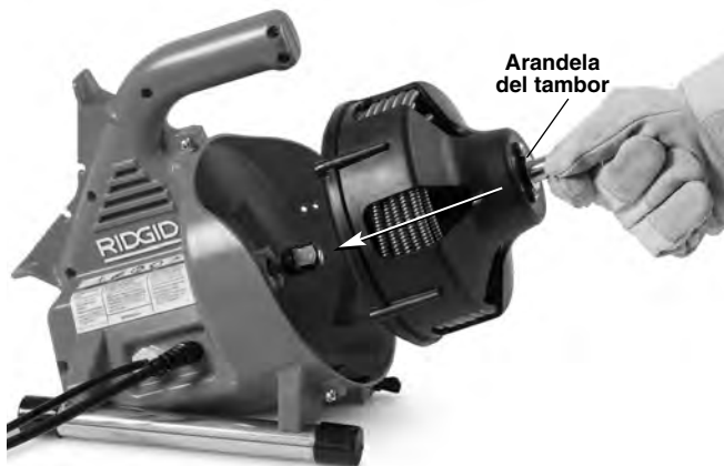
Figura 16 – Colocación del tambor dentro de la máquina
