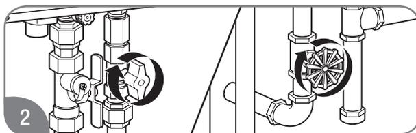
2 Cierre las válvulas de paso para apagar el gas y el agua del calentador de agua.
