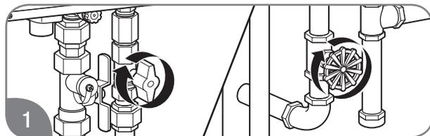
Cierre las válvulas de paso para apagar el gas y el agua del calentador de agua.
