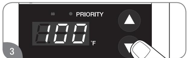
Presione el botón de ajuste ▼ repetidamente hasta que la pantalla LED muestre el ajuste de temperatura más bajo.
