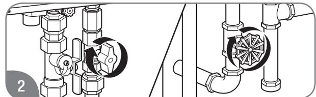
Cierre las válvulas de paso para apagar el gas y el agua del calentador de agua.
