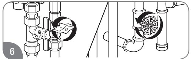
6 Abra las válvulas de paso para encender el gas y el agua del calentador de agua.
