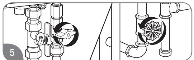
Abra las válvulas de paso para encender el gas y el agua del calentador de agua.
