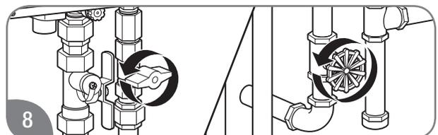
Abra las válvulas de paso para encender el gas y el agua del calentador de agua.
