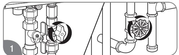
1 Cierre las válvulas de paso para apagar el gas y el agua del calentador de agua.
