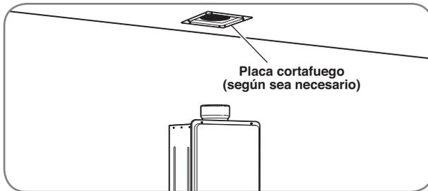
Cualquier tubo de ventilación que atraviese un piso o un techo, que no esté contenido en una canalización resistente al fuego, requiere de una placa cortafuego.
