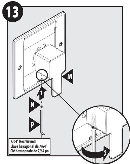
Secure handle with Set Screw (N) with Hex Wrench (P). Sujete el monomando con el tornillo de fijación (N) usando la llave hexagonal (P).
