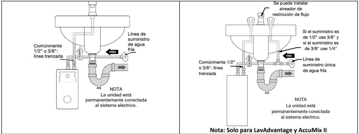
Abra la canilla de agua caliente y deje correr agua por al menos 60 segundos y hasta que el caudal sea continuo y no tenga burbujas de aire. Cierre la canilla e instale el aireador (si viene con el aparato).
