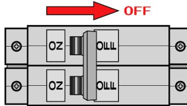
Para usar exclusivamente con un ramal eléctrico individual. El calentador debe instalarse con un ramal individual, con cable aislado de 2 hilos (2 hilos más tierra), aceptado por UL, del tamaño apropiado para una temperatura de hasta 75°C y protegido por un disyuntor de la clase apropiada.
