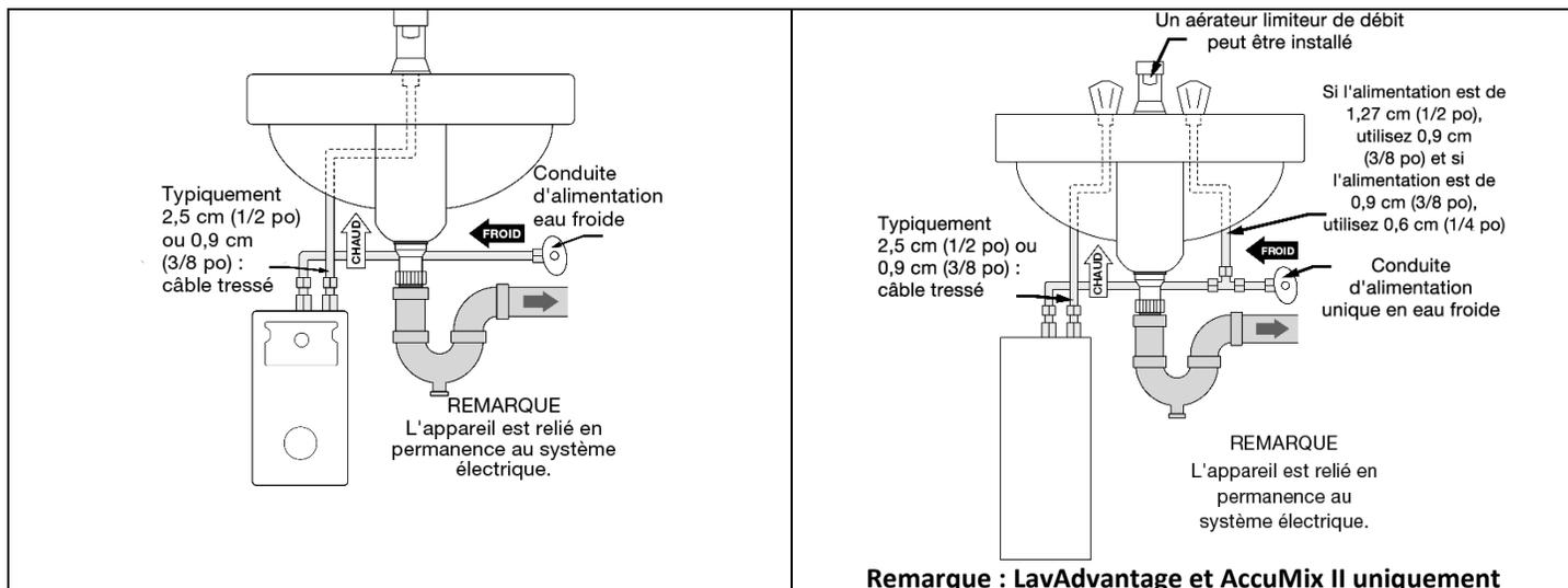
Ouvrez le robinet d'eau chaude et faites couler l'eau pendant au moins 60 secondes et jusqu'à ce que le débit soit continu et exempt de poches d'air. Fermez le robinet et installez l'aérateur (si fourni).
