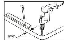
4. Utilice una caladora para comenzar a cortar por la línea de calado desde el orificio perforado. Sostenga la parte calada hasta completar el corte.
