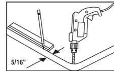
4. À l'aide d'une scie à découper, commencer à couper du trou percé le long de la ligne du pourtour de découpe. Soutenir la découpe jusqu'à ce que la coupure soit complète.
