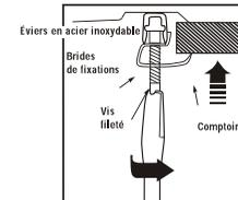
9. Tourner la bride sur l'attache de 90 degrés vers le canal, puis serrer la vis dans le sens des aiguilles d'une montre depuis l'attache centrale à l'aide d'un long tournevis.
