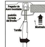
9. Gire la pinza de sujeción del clip 90 grados hacia el canal y utilice un destornillador largo para ajustar en sentido horario el tornillo del clip central.
