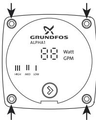
Fig. 4 Desenrosque los cuatro tornillos de cabeza hexagonal del cabezal de potencia para cambiar su posición
