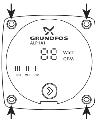
Fig. 4 Retirer les quatre vis à tête creuse sur la tête de pompe pour changer la position de la tête de pompe
