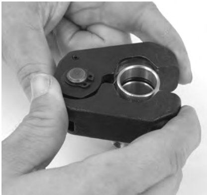
Figura 9 – Montaje del aro sellador en el acoplamiento
