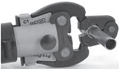
Abbildung 10 – Ansetzen der Ringbacke am Pressring
