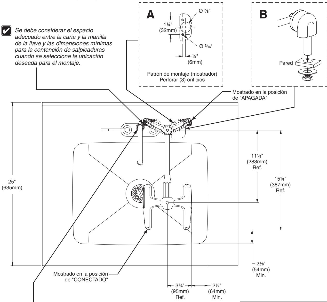
**C** Se puede usar también una manguera flexible (provista por el instalador) con terminación de rosca hembra de  $\frac{1}{2}$ " (12,8 mm) NPT.
