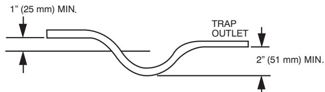
Fig. 8 - Condensate Trap
