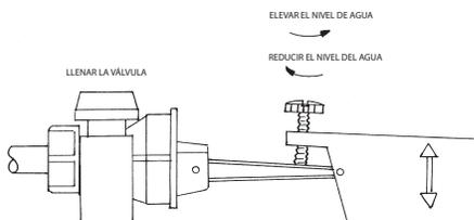
Abrir lentamente la válvula de cierre y verificar si hay filtraciones. Llenar la cubeta de volcado EcoLogic® hasta la marca del nivel de agua. Ajustar el nivel, si es necesario, girando el tornillo negro en la parte superior del flotante. Girar el tornillo a la derecha para reducir y hacia la izquierda para elevar el nivel de agua.
