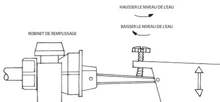
Ouvrez lentement le robinet d'arrêt et vérifiez qu'il n'y a pas de fuites. Remplissez le récipient à bascule EcoLogic® jusqu'à la ligne d'eau. Ajustez le niveau, si nécessaire, en tournant la vis noire sur le dessus du flotteur. Tournez la vis vers la droite pour baisser le niveau de l'eau ou vers la gauche pour hausser le niveau de l'eau.
