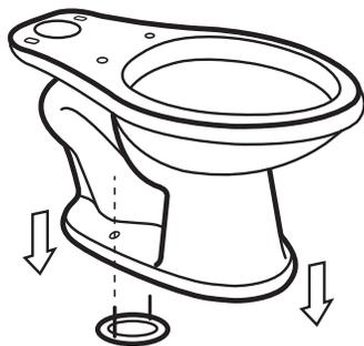
Baissez la cuvette de toilette avec soin sur la bride de sol tout en alignant les boulons en « T » à travers les deux trous du pied de la cuvette de toilette.
