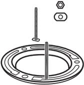
Instalar los nuevos pernos "T" con arandelas planas alargadas de latón y tuercas (de traba) finas de latón y cabeza hexagonal.
