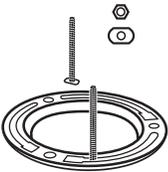
Installez de nouveaux boulons en « T » avec rondelles plates allongées et écrous minces à tête hexagonale en laiton (contre-écrous).
