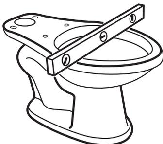
Assurez-vous que la cuvette de toilette est de niveau. Si la toilette bascule ou se balance, insérez des cales sous le socle.
