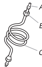
A. Bague de compression C. Tube en cuivre B. Écrou de compression
