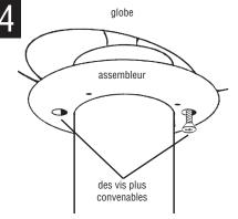
ATTACHEZ LE GLOBE AU ASSEMBLEUR. Glissez le bord du globe entre le remplisseur et une bride. Poussez l'autre bride douille. Sovez sûr d'employer l'ampoule avec la puissance en dans le globe. Globe central sur le assembleur. Serrez deux vis plus convenables pour fixer le globe au assembleur.
