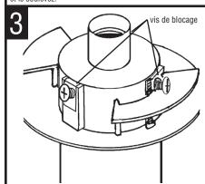
PLACEZ LE ASSEMBLEUR au-dessus du poteau comme montré. Serrez les vis de blocage. Installez l'ampoule sur la watts aucun plus grand qu'indiqué pour ce montage.
