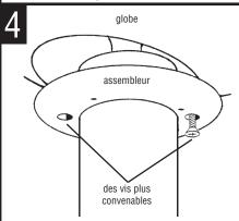
PLACEZ LE ASSEMBLEUR au-dessus du poteau comme ATTACHEZ LE GLOBE AU ASSEMBLEUR. Glissez le bord du montré. Serrez les vis de blocage. Installez l'ampoule sur la 🛮 globe entre le remplisseur et une bride. Poussez l'autre bride douille. Sovez sûr d'employer l'ampoule avec la puissance en dans le globe. Globe central sur le assembleur. Serrez deux vis plus convenables pour fixer le globe au assembleur.
