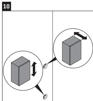
> Enlevez toutes les prises de la paroi arrière intérieure de l'armoire pour dévoiler des vis qui permettent d'ajuster l'unité. La vis supérieure s'ajustera de l'avant à l'arrière, et la vis inférieure s'ajuste de haut en bas.
