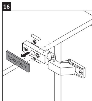
> Retirando la cubierta abatible Duravit de plástico se accede a los tres tornillos Phillips.
