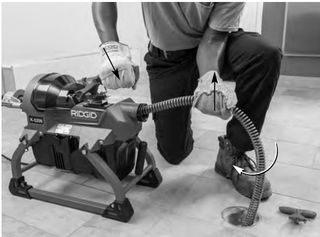
Figure 14A – Retrait du câble de la canalisation avec embrayage engagée et câble en rotation
