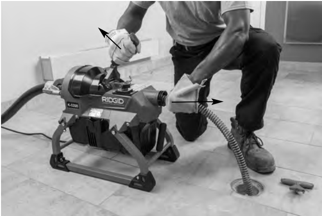
Figure 11B – Embrayage ramené, câble arrêté, extraction d'une longueur de câble de la machine
