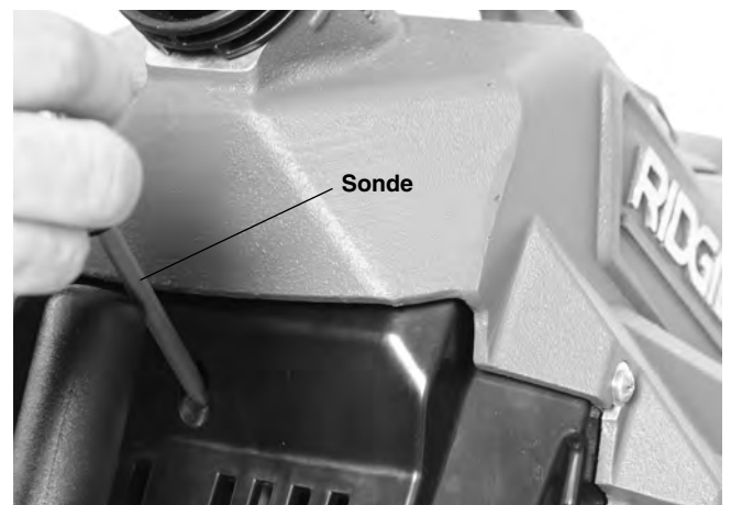
Figure 22 – Bouton de réarmement du moteur
