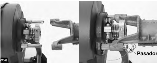
Figura 6 – Conexión de la manguera guía trasera
