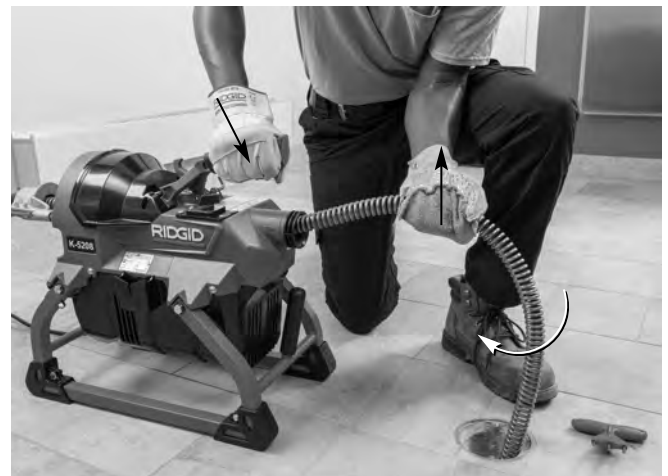
Figura 14 A – Con el embrague activado, mientras gira el cable, se jala el cable para sacarlo del desagüe
