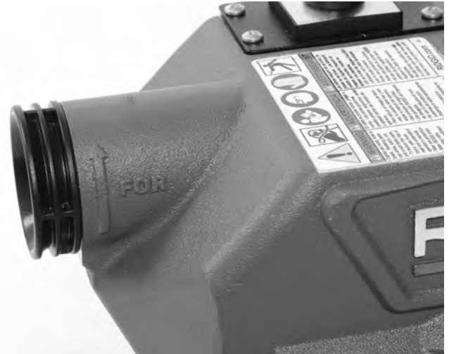
Figure 10 – Marquage du sens de rotation « FOR »
