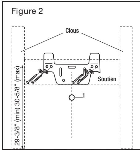
**REMARQUE :** Le support du lavabo est protégé sous le rabat inférieur du carton! Pour l'installation de lavabos avec des bras de support dissimulés ou exposés, suivez les instructions fournies par le fabricant des bras de support. Les bras de support ne sont PAS fournis.
