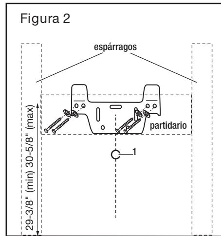
**NOTA:** ¡el colgador del lavabo está protegido debajo de la pestaña inferior de la caja! Para la instalación de lavabos con vigas de soporte ocultas o expuestas, siga las instrucciones suministradas por el fabricante de las vigas de soporte. No incluye las vigas de soporte.
