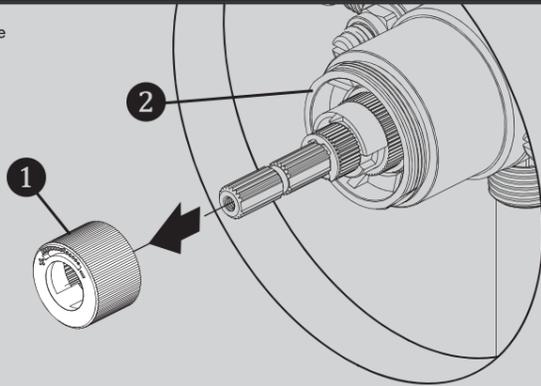
ADJUSTING THE TEMPERATURE LIMITER
