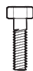
Vis à bois ou boulon d'ancrage de diamètre extérieur de 12,7 mm (1/2 po)
