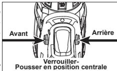
Pour une rotation **en marche arrière** (dans le sens anti-horaire), pousser le commutateur sur le côté gauche de l'outil. **Vérifier la direction de rotation avant utilisation.**
