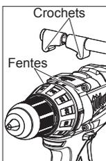
2. Pour retirer la poignée latérale, desserrer la prise de celle-ci jusqu'à ce que la poignée soit libérée. Remplacer de nouveau la poignée et la fixer solidement.
