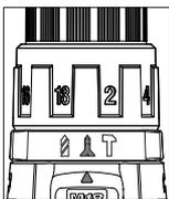
Bien réglé, l'embrayage réglable glisse à un couple pré-réglé pour éviter de visser trop profondément dans différents matériaux et pour éviter d'endommager la vis ou l'outil.
