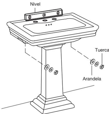
Instale las tuercas y las arandelas y apriete hasta que queden debidamente enroscadas.
