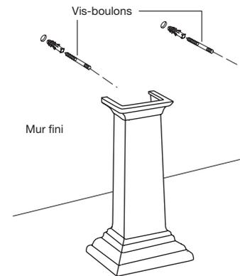
Percez deux trous de 6,4 mm (1/4 po) pour les vis-boulons dans le mur, à l'endroit où vous avez tracé les marques.
