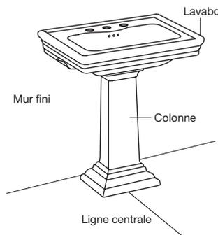
Tracez une ligne centrale sur le plancher.
